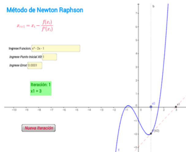
Figura 2. OA para visualizar la interpretación geométrica del método de Newton Raphson
